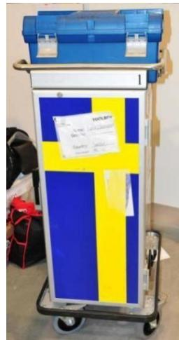
Все оборудование, включая маленькие ящики для инструментов, должно полностью помещаться в ящик для инструментов. Объем ящика для инструментов не должен превышать 0,3 м<sup>3</sup>. Следует использовать ящики с колесами для облегчения их перемещения. Площадь основания не более 0,7 м x 0,7 м.
